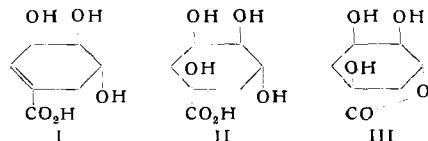
möglich, Chinasäure direkt durch Wasserabspaltung in Shikimisäure zu überführen, weil sich bevorzugt ein Lacton III bildet. Diese Schwierigkeit läßt sich umgehen, indem man Chinasäure auf bekannte Weise in Tetraacetyl-chinasäure umwandelt und deren Chlorid IV mit Natrium-trimethoxyborhydrid  $NaBH(OCH_3)_3$ <sup>11)</sup> reduziert. Dieses Reagens greift nur an der Säurechlorid-Gruppe an, ohne die Acetyl-Gruppen abzuspalten. Gleichzeitig
