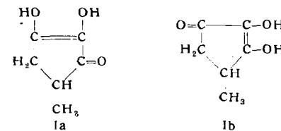
Die Synthese dieser Verbindung<sup>3)</sup> ergab tatsächlich zwei Isomere, die sich wechselseitig ineinander umwandeln lassen. Mit 2,4-Dinitrophenyl-hydrazin liefern beide das gleiche Osazon, das auch aus dem Brenzdestillat erhalten wurde. Der Vergleich der Reduktinsäure selbst offenbarte jedoch Unterschiede, die aus Materialmangel seinerzeit nicht geklärt werden konnten.
